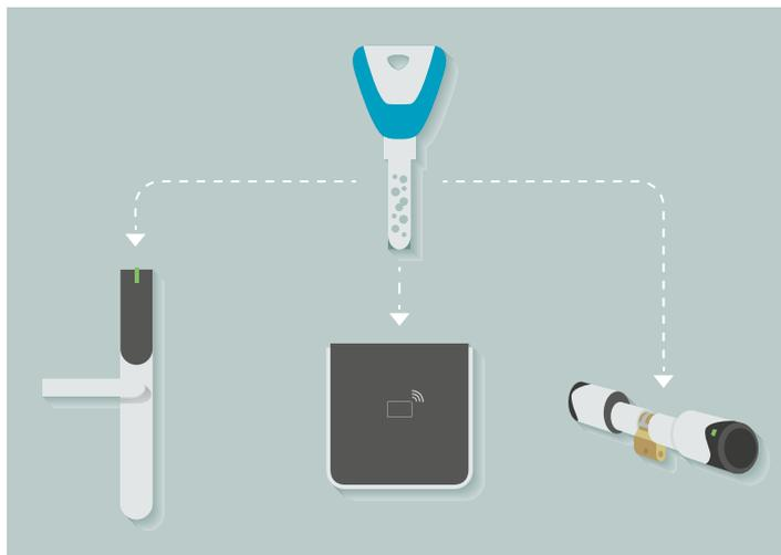
KESO 8000Ω<sup>2</sup> Schliessanlagen sind kompatibel mit mechatronischen und elektronischen Komponenten der KESO-Integra-Plattform. Mittels eines 2nd RFID Transponder im Schlüssel können auch andere Systeme wie z.B. die Zeiterfassung bedient werden.
